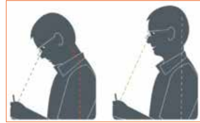
Abb. 6 Vergleich einer normalen Lupenbrille mit Prismatischer Lupenbrille.
